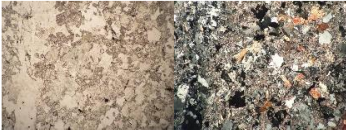
Figure 71: Pamje e mostres me derite te polarizuar (a) dhe analizator (b). Zmadhuar 10 here. Përveç mineraleve të kuarcit në këto pamje vërohet sericitizimi i mineraleve të feldshpateve që përbejnë pjesën më të madhe të shkëmbit, kuarci dhe kloritoidet.
