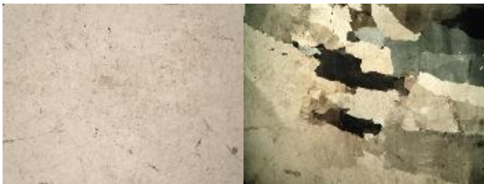
Figure 76: Pamje e mostres me derite te polarizuar (a) dhe analizator (b). Zmadhuar 10 here. Ne kete moster vrojtohen vetem minerale te kuarcit.
