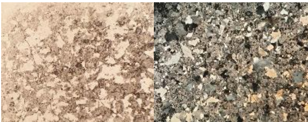
Figura 67: Pamje e mostres me derite te polarizuar (a) dhe analizator (b). Zmadhuar 10 here. Pervец mineraleve të kuarcit në kete pamje vrojtohet sericitizimi i mineraleve të feldshpateve qe perbejne pjesen më të madhe të shkëmbit.
