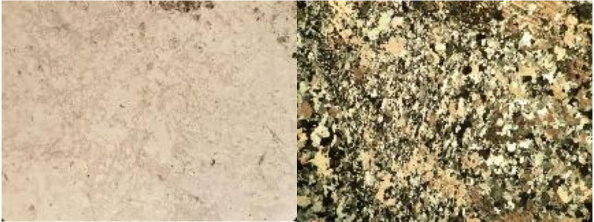
Figure 74: Pamje e mostres me derite te polarizuar (a) dhe analizator (b). Zmadhuar 10 here. Ne keto foto mikroskopike vrojtohen mineralet e kuarcit te orjentuar sipas planeve te shistozitetit si dhe vrojtohen qarte mineralet e kalcitit.
